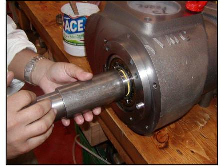
Il montaggio del paraolio deve essere conforme alla normativa DIN3760
